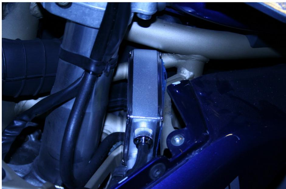
Solitamente nei kit c'è in dotazione una staffetta per agevolare il fissaggio del ballast, in questo caso l'ho fissato con delle fascette, ma è solo una soluzione temporanea.
