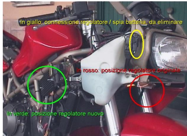
In giallo: Connessioni impianto elettrico / regolatore
